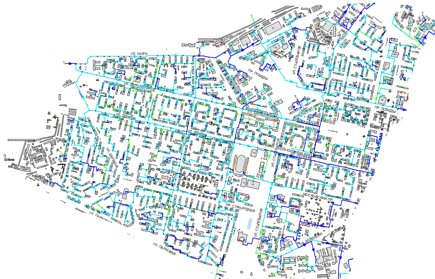
На Рис. 2.1.1.6.1 показаны красным, желтым и зеленым цветом участки тепловых сетей, на которых удельные потери на трение превышают нормативные значения.
