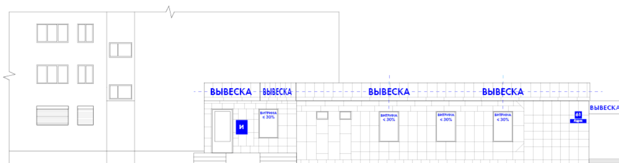
Рис. 52. Допустимое размещение конструкций на встроенно-пристроенном помещении
