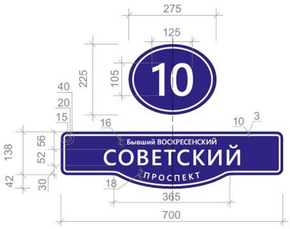
Рис. 45. Оформление домового знака в границах территории исторического поселения регионального значения город Череповец, за исключением зон Р-1, Р-2 (размеры указаны в миллиметрах).
